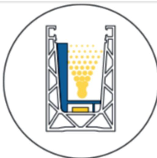
Sistemas de drenaje: Siempre seco. El sistema GlassFit SV-1702 Side cuenta con una secuencia de orificios de drenaje que permiten una evacuación eficaz de agua desde su interior. Además, todas las posibilidades de instalación admiten el perfil de drenaje DP-01 que optimiza la escorrentía de agua hacia el exterior.
