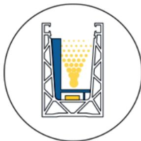
Tecnología LED: Gracias al nuevo diseño de los calzos, que permiten la posibilidad de añadir iluminación LED, el sistema de barandillas ya pueden efectuar funcionalidades de ambientación y señalización.
